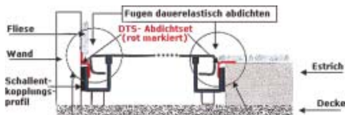
Bild 12: Einbau einer barrierefreien Duschanne aus Stahl. (Beispiel – Werkbild DTS Kaldewei)
