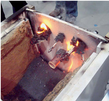
Demonstration des Brandverhaltens von verschiedenen Leitungsdurchführungen.
