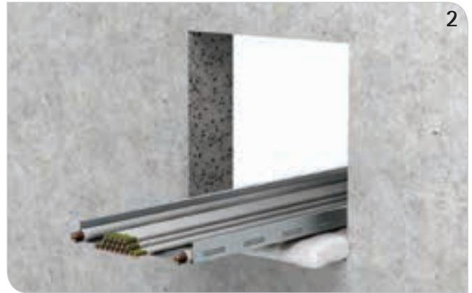
Nach Möglichkeit die erste Lage BIS Pacifyre® IWC Brandschutzkissen unter die Kabeltragschiene oder das Kabelbündel platzieren.
