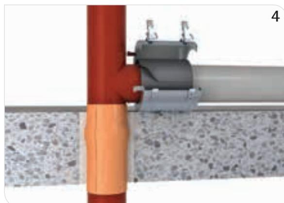
*Blechgehäuse der BIS Pacifyre® KonFix Hülse öffnen, bündig um das Band legen, Laschen schließen und mit dem Metallspannband fest am Rohr fixieren.*
