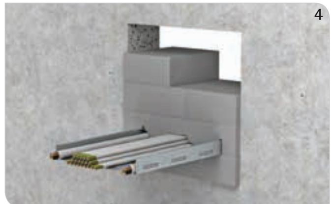
Brandschutzkitt um die Kabel in der Öffnung auf einer Länge von mindestens 10 cm auftragen und weitere BIS Pacifyre® IWS Brandschutzsteine auflegen.
