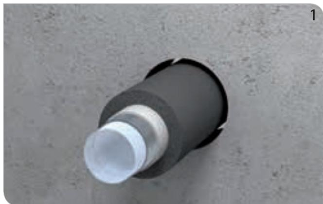
Rohrleitung (ggf. mit Synthesekautschukdämmung) installieren.
