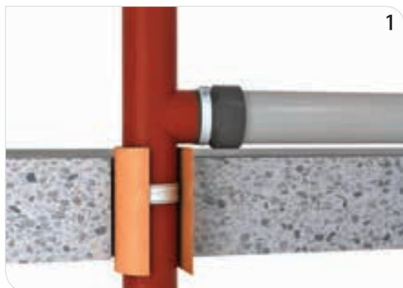
*BIS Pacifyre® SML Flex Brandschutzmatte einlagig um das Rohr legen, in das Bauteil schieben und andrücken.*
