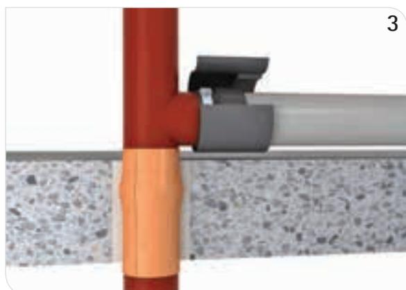
*Intumeszierendes Band der BIS Pacifyre® KonFix Hülse um den Verbinder und das Kunststoffrohr wickeln.*
