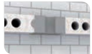
Porenbetondecke (ggf. mit Hohlkammern)
