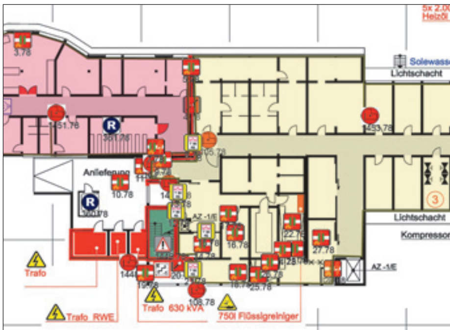
Bild 4 · Probleme mit der Mischverlegung – Beispiel aus einer Großküche.
