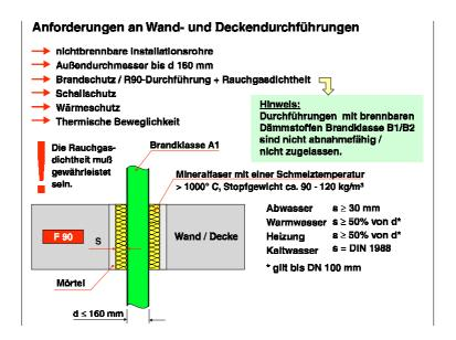
Bei nichtbrennbaren Installationsrohren müssen die genannten Maßnahmen zur Erreichung der R90-Qualität durchgeführt werden. Brennbare Dämmstoffe sind im Wand- und Deckendurchführungsbereich nicht zulässig, wenn keine besonderen Maßnahmen mit R90-Zulassung getroffen werden.
