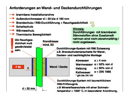
Wand- und Deckendurchführungen mit brennbaren Installationsrohren benötigen Brandschutz-manschetten mit R90-Zulassung des DIBt, Berlin. Die Brandschutzmanschetten sind nur in Verbindung mit den geprüften und zugelassenen Rohrwerkstoffen zu montieren.. Die gezeigte Skizze zeigt die Anforderung R90-Qualität (Farbe gelb) auf, nicht jedoch die Details einer Brandschutzmanschette.
