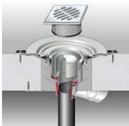
Bild 4: Viega Bodenablauf Adventix in R 120-Qualität.
