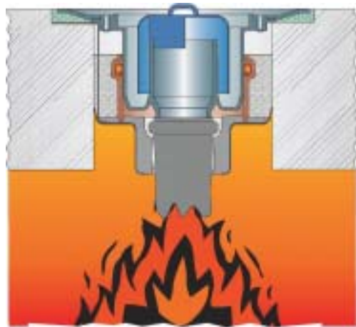
Bild 1: Dallmer Bodenablauf bei Brandbeginn.
