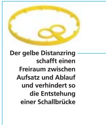
Der gelbe Distanzring schafft einen Freiraum zwischen Aufsatz und Ablauf und verhindert so die Entstehung einer Schallbrücke
