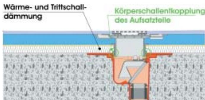
Bild 4: Schalltechnische Entkopplung Bodenablauf zum Aufsatzstück.
