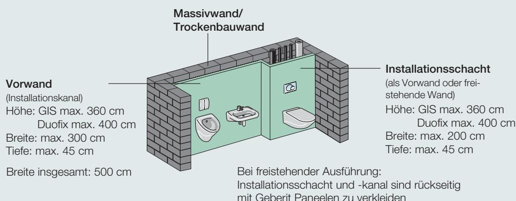
Abbildung 5: Geberit Quattro – Maximale Abmessungen
